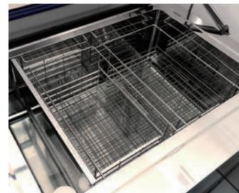
凍結浸漬槽の周囲に霜がつかない機構を採用。また、不凍液の不純物を濾過するフィルター付き。
