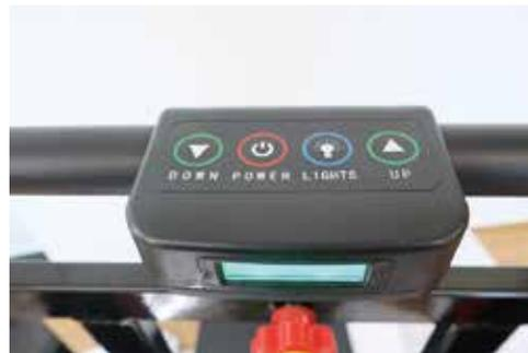
階段台車の操作は手元のボタンで行います。ボタンを押している間のみ動き、手を離せば停止するので安全に走行することができます。
