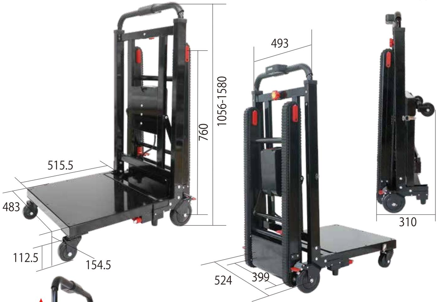
使用できる階段の最大角度は最大 35 度、走行スピードは 3 段階調整可能で約 20 ~ 36 段 / 分となります。最大の特徴は荷台部分を折り畳み可能なことです。折り畳み時は幅約 30cm となるので、使用しない時はコンパクトに片付けておくことができます。最大積載量は 150kg とパワフル。冷蔵庫や洗濯機などの大型家電に、タンスや机などの家具、ビール瓶ケースやペットボトル飲料など、重い荷物を載せても階段を昇り降りできます。
