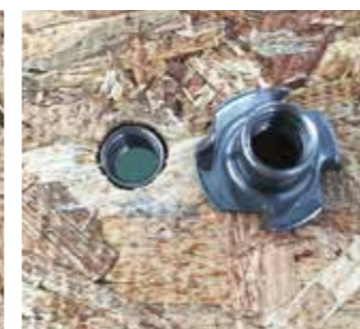
穴加工とボルト固定用つめ付きTナット
